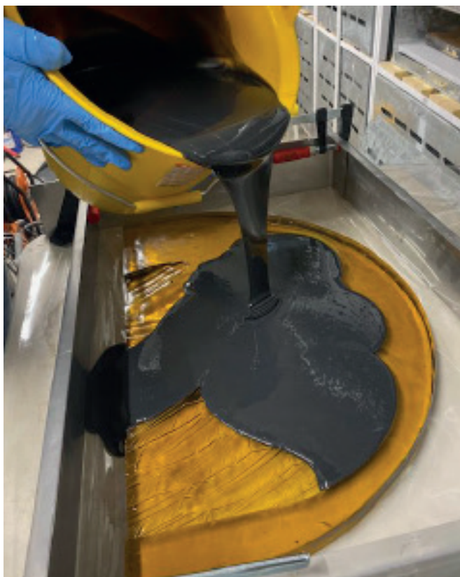
Coulage du silicone à double composant
